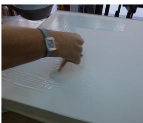
encoller le bâti avec la même colle
