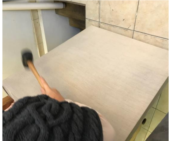
Décatir à l'eau chaude+ laisser sécher 8h et décatir au maillet
